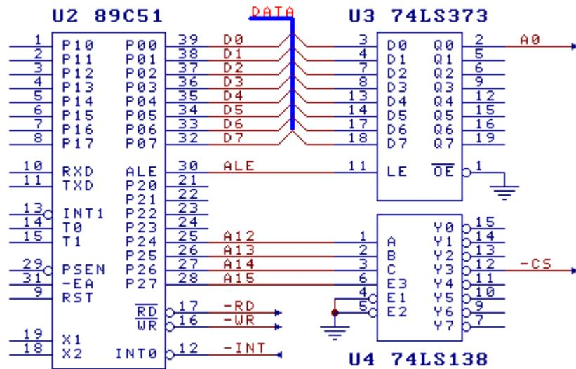
CH372 芯片具有通用的被动并行接口，可以直接连接多种单片机、DSP、MCU 等。在普通的 MCS-51 系列单片机的典型应用电路中，CH372 芯片可以通过 8 位被动并行接口的 D7~D0、-RD、-WR、-CS、A0 直接挂接到单片机 U2 的系统总线上。
