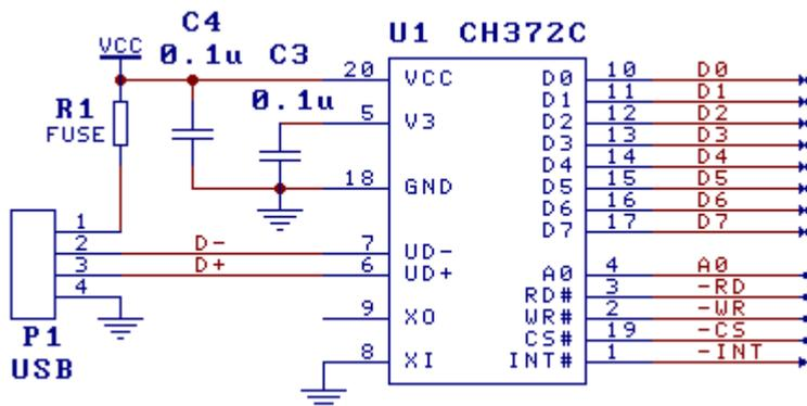
如果使用内置时钟的 CH372C 芯片，那么可以免去外部晶体及振荡电容，电路更简洁。
