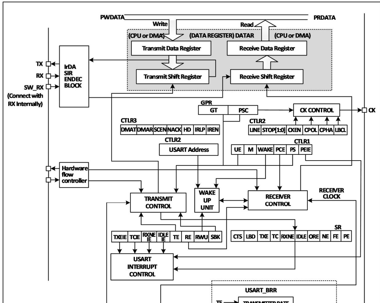
当 TE (发送使能位) 置位时，发送移位寄存器里的数据在 TX 引脚上输出。在发送时，最先移出的是最低有效位，每个数据帧都由一个低电平的起始位开始，然后发送器根据 M (字长) 位上的设置发送八位或九位的数据字，最后是数目可配置的停止位。如果配有奇偶检验位，数据字的最后一位为校验位。在 TE 置位后会发送一个空闲帧，空闲帧是 10 位或 11 位高电平，包含停止位。断开帧是 10 位或 11 位低电平，后跟着停止位。
