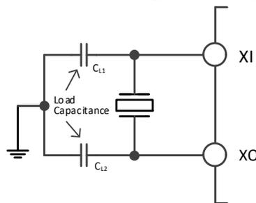
注：负载电容需要尽可能地靠近振荡器引脚，并根据晶体厂家参数选择容值。
