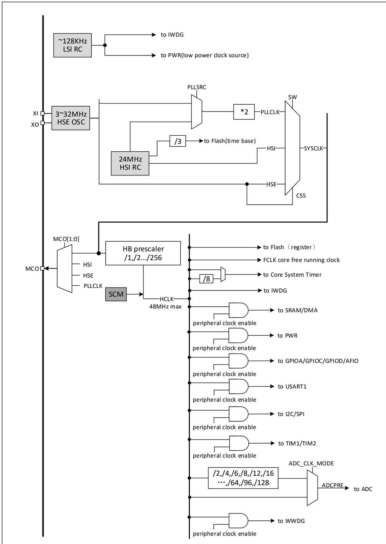
图 3-3 CH32V005、CH32V006 时钟树框图
