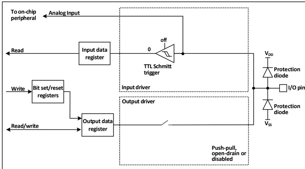
在启用模拟输入时，输出缓冲器被断开，输入驱动中施密特触发器的输入被禁止以防止产生 I/O 口上的消耗，上下拉电阻被禁止，读取输入数据寄存器将一直为 0。
