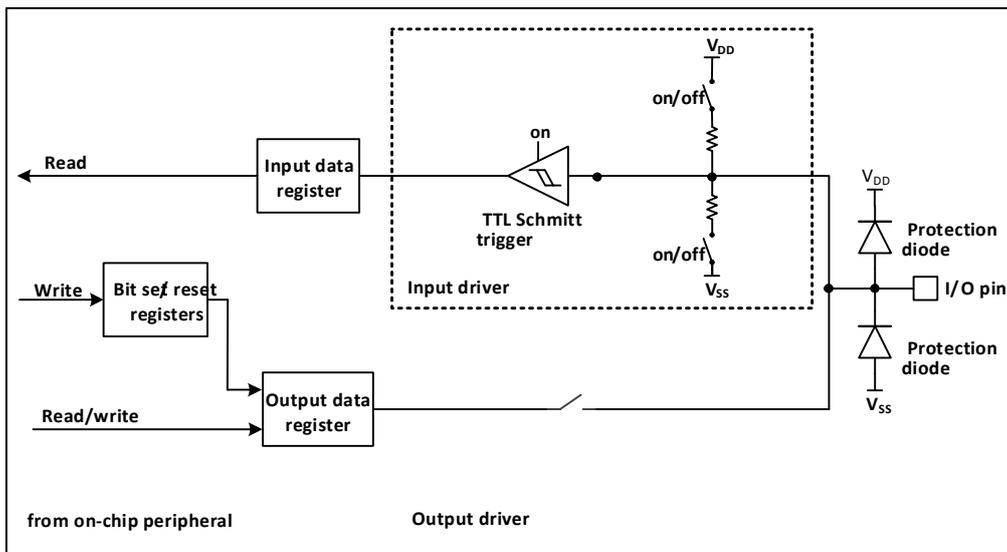
当 IO 口配置成输入模式时，输出驱动断开，输入上下拉可选，不连接复用功能和模拟输入。在每个 IO 口上的数据在每个 HB 时钟被采样到输入数据寄存器，读取输入数据寄存器对应位即获取了对应引脚的电平状态。
