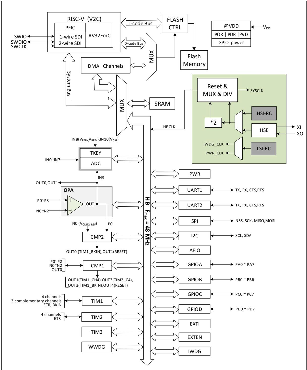
图 1-5-1 CH32M007G8R6 系统框图
