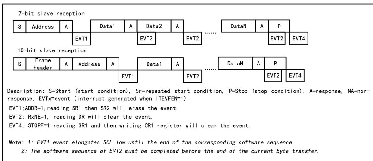
主设备在传输完最后一个数据字节后，将产生一个停止条件，当 I2C 模块检测到停止事件时，将置 STOPF 位，如果设置了 ITEVFEN 位，还会产生一个中断。用户需要读取状态寄存器 (R16\_I2C1\_STAR1) 再写控制寄存器（比如复位控制字 SWRST）来清除。（见上图中的 EVT4）。
