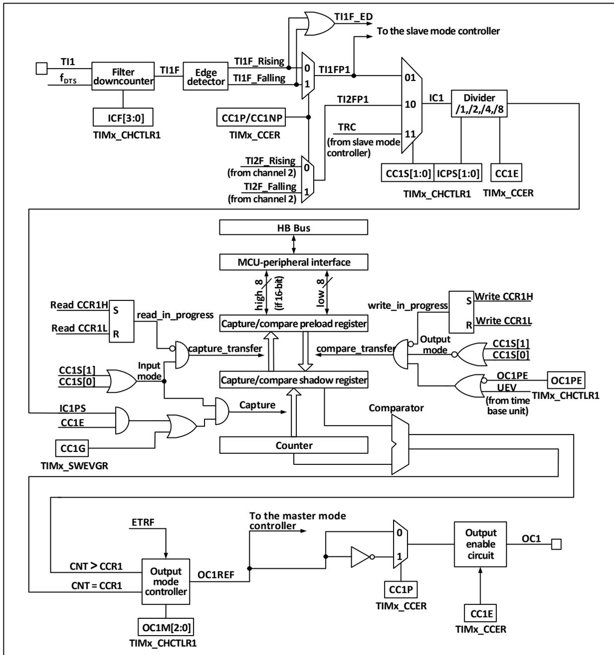
信号从通道  $x$  引脚输入进来后可选做为  $TI_x$  ( $TI_1$  的来源可以不只是  $CH_1$ ，见定时器的框图 12-1)， $TI_1$  经过滤波器 (ICF[3:0]) 生成  $TI_1F$ ，再经过边沿检测器分成  $TI_1F\_Rising$  和  $TI_1F\_Falling$ ，这两个信号经过选择 (CC1P) 生成  $TI_1FP_1$ ， $TI_1FP_1$  和来自通道 2 的  $TI_2FP_1$  一起送给  $CC_1S$  选择成为  $IC_1$ ，经过  $ICPS$  分频后送给比较捕获寄存器。
