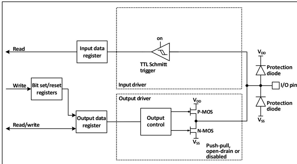
当 I/O 口配置成输出模式时，输出驱动器中的一对 MOS 可根据需要被配置成推挽或开漏模式，不使用复用功能。输入驱动的上下拉电阻被禁用，TTL 施密特触发器被激活，出现在 I/O 引脚上的电平将在每个 HB 时钟被采样到输入数据寄存器，所以读取输入数据寄存器将会得到 I/O 状态，在推挽输出模式时，对输出数据寄存器的访问就会得到最后一次写入的值。
