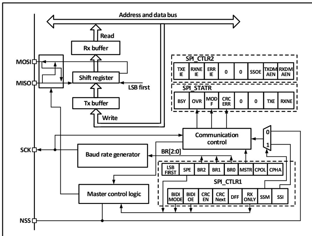
由图 16-1 可以看出，与 SPI 相关的主要是 MISO、MOSI、SCK 和 NSS 四个引脚。其中 MISO 引脚在 SPI 模块工作在主模式下时，是数据输入引脚；工作在从模式下时，是数据输出引脚。MOSI 引脚工作
