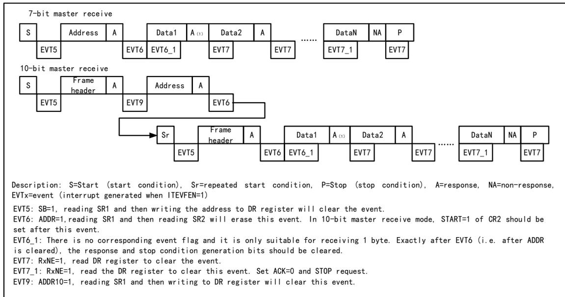
主设备在结束发送数据时，会主动发一个结束事件，即置 STOP 位，I2C 将切换至从模式。在接收模式时，主设备需要在最后一个数据位的应答位置 NAK，接收到 NACK 后，从设备释放对 SCL 和 SDA 线的控制；主设备就可以发送一个停止/重起始条件。注意，产生停止条件后，I2C 模块将会自动切换至从模式。
