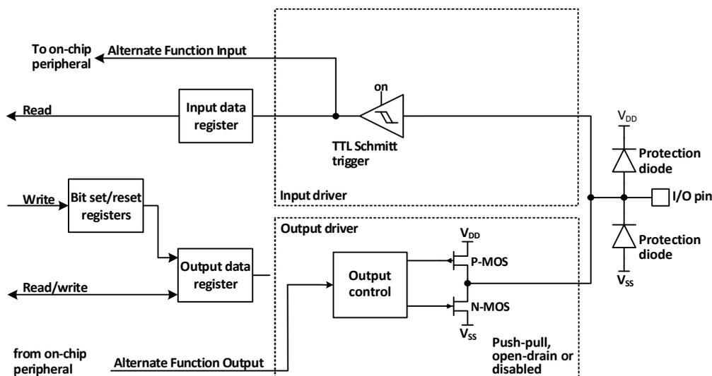
在启用复用功能时，输出驱动器被使能，可以按需要被配置成开漏或推挽模式，施密特触发器也被打开，复用功能的输入和输出线都被连接，但是输出数据寄存器被断开，出现在 I/O 引脚上的电平将在每个 HB 时钟被采样到输入数据寄存器，在开漏模式下，读取输入数据寄存器将会得到 I/O 口当前状态；在推挽模式下，读取输出数据寄存器将会得到最后一次写入的值。
