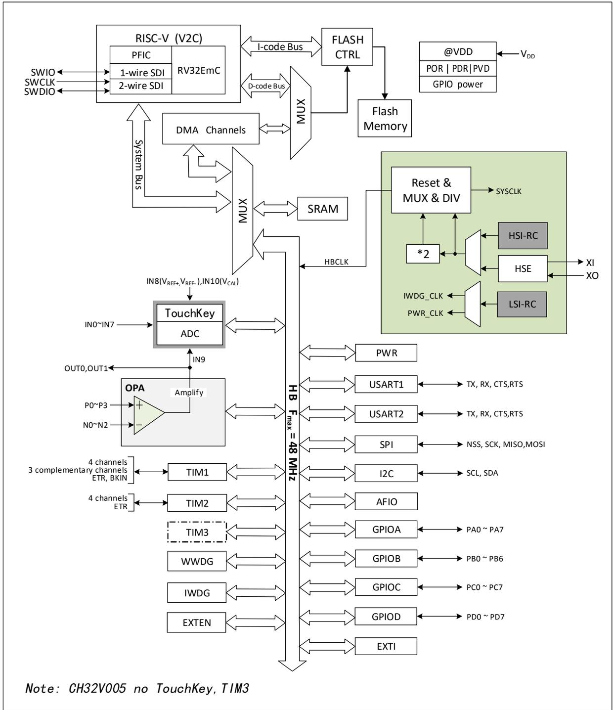
图 1-4 CH32V007 系统框图
