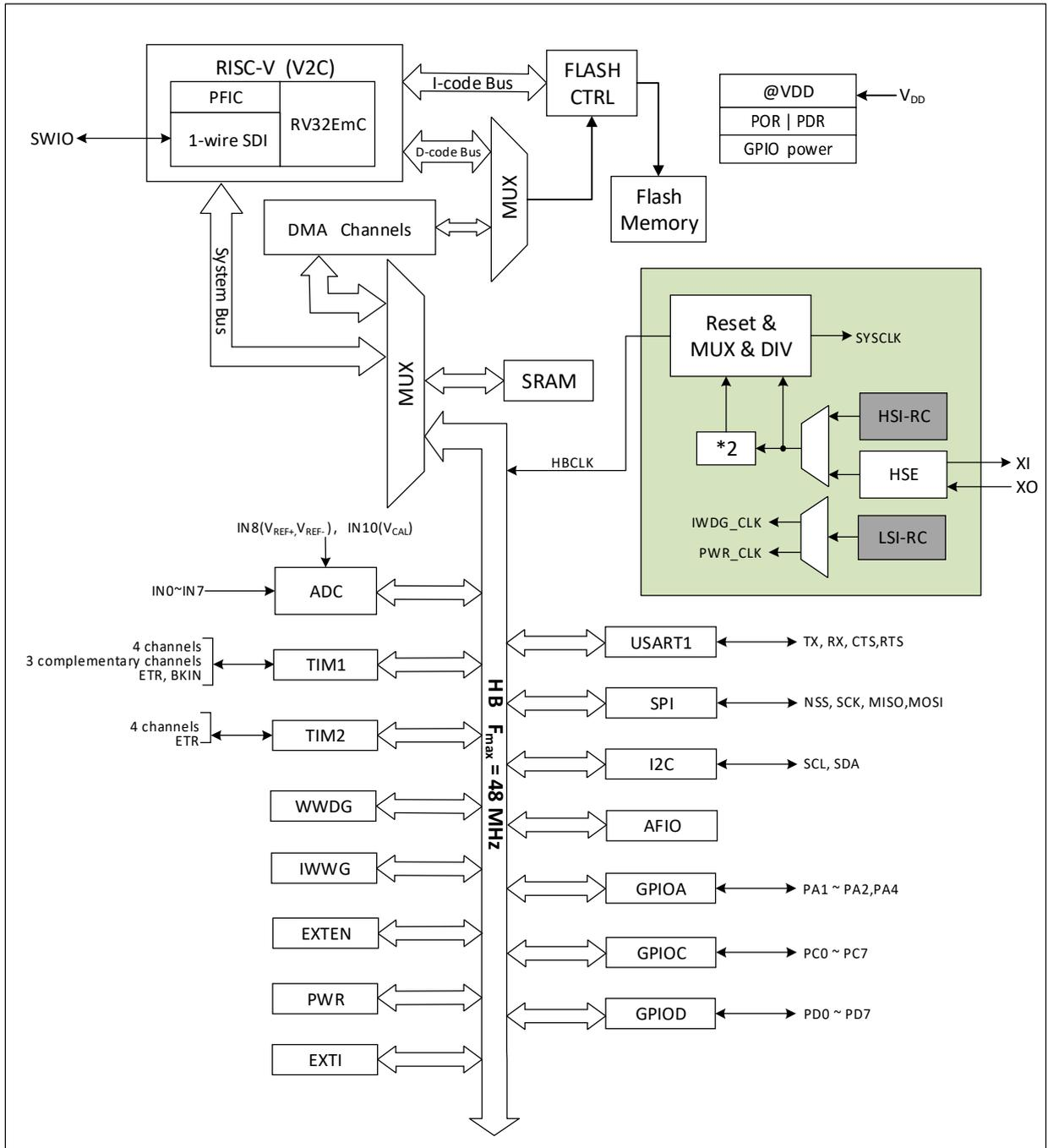
图 1-3 CH32V005、CH32V006 系统框图
