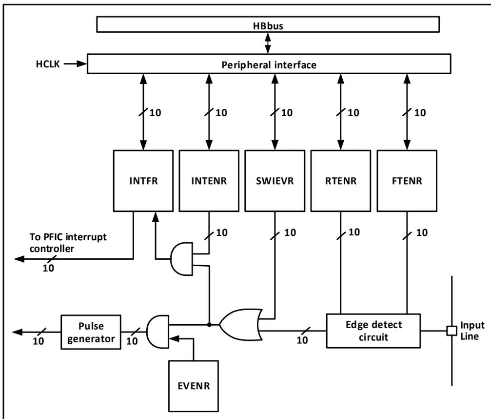
由图 6-1 可以看出，外部中断的触发源既可以是软件中断 (SWIEVR) 也可以是实际的外部中断通道，外部中断通道的信号会先经过边沿检测电路 (edge detect circuit) 的筛选。只要产生软件中断或外部中断信号其一，就会通过图中的或门电路输出给事件使能和中断使能两个与门电路，只要有中断被使能或事件被使能，就会产生中断或事件。EXTI 的六个寄存器由处理器通过 HB 接口访问。
