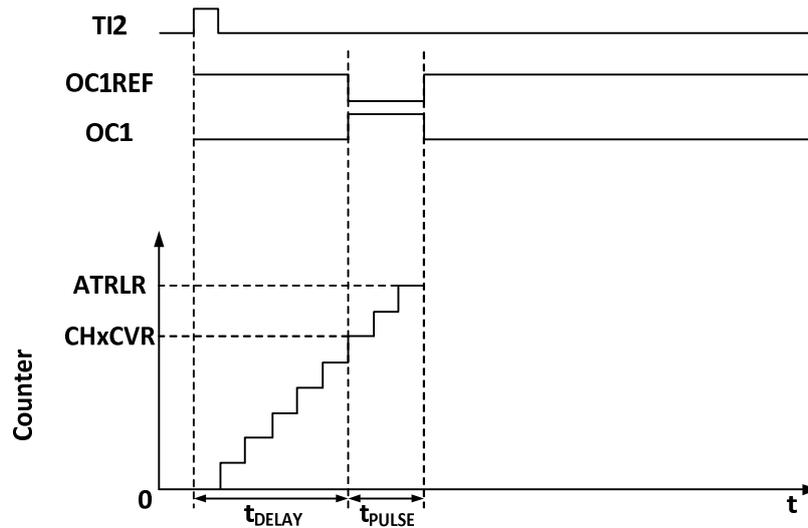
如图 12-4 所示，需要在 TI2 输入引脚上检测到一个上升沿开始，延迟  $T_{delay}$  之后，在 OC1 上产生一个长度为  $T_{pulse}$  的正脉冲：
