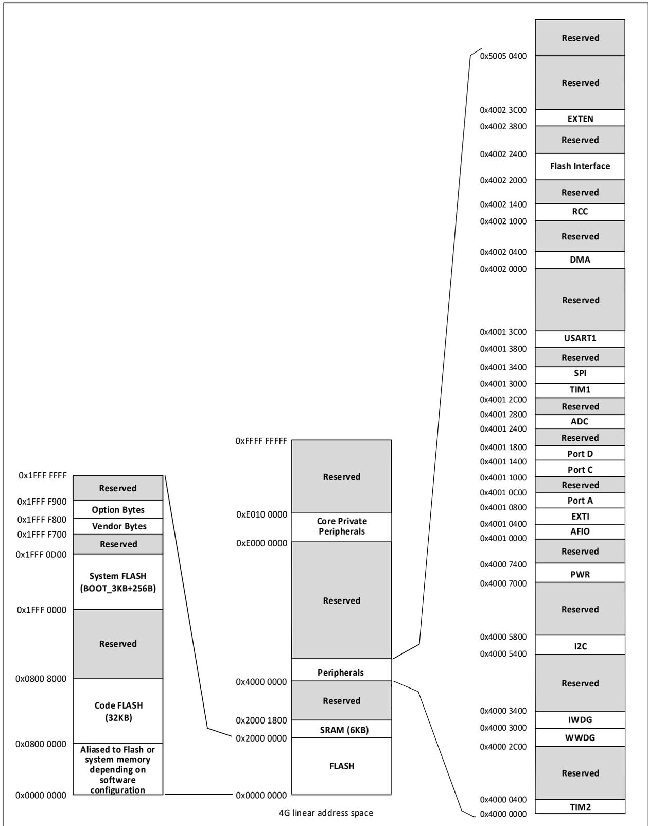
图 1-8 CH32V005、CH32V006 存储映像
