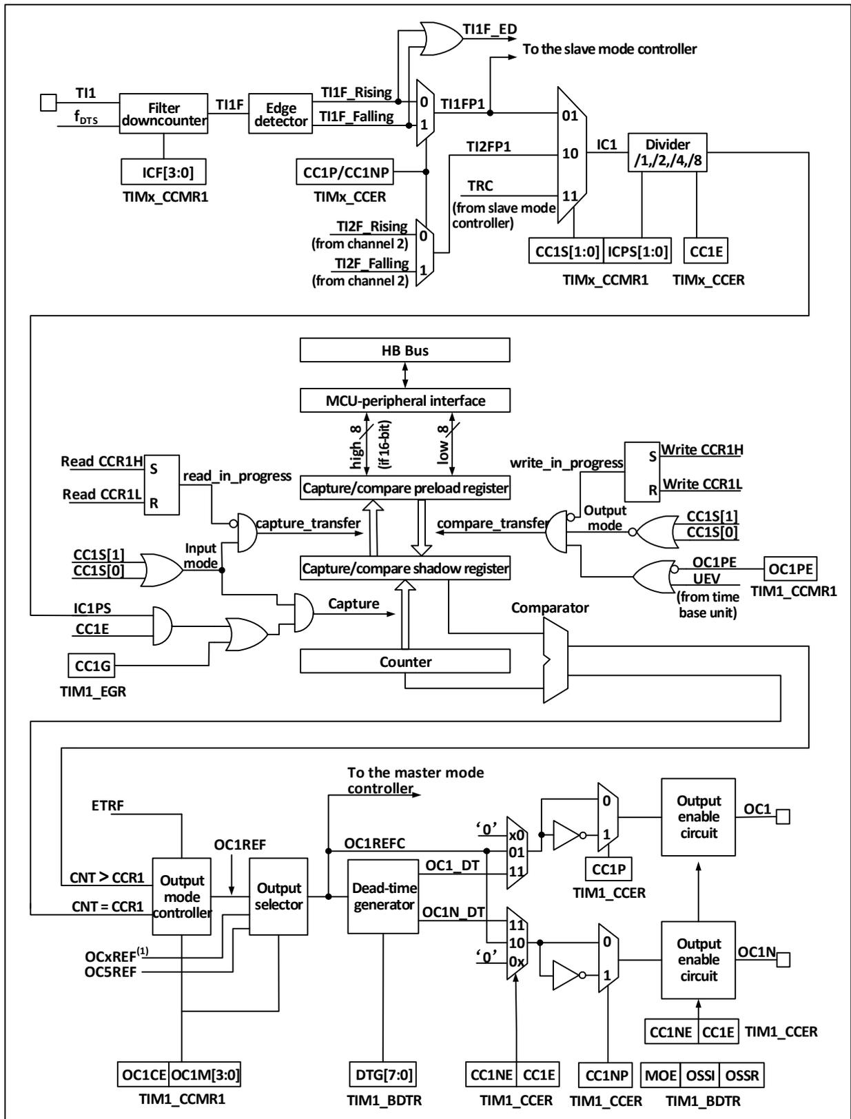
比较捕获通道的结构框图如图 11-3 所示。信号从通道 x 引脚输入进来后可选做为 T1x (T11 的来源可以不只是 CH1, 见定时器的结构框图 11-1), T11 经过滤波器 (ICF[3:0]) 生成 T11F, 再经过边沿检测器分成 T11F\_Rising 和 T11F\_Falling, 这两个信号经过选择 (CC1P) 生成 T11FP1, T11FP1 和来自通道 2 的 T12FP1 一起送给 CC1S 选择成为 IC1, 经过 ICPS 分频后送给比较捕获寄存器。
