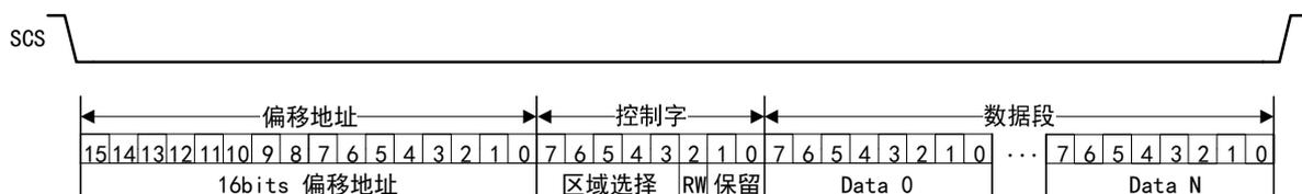
CH394Q 支持对数据进行连续的读取或写入操作，从起始地址开始，每传输完一个偏移地址的数据后，偏移地址会自动加 1 传输接下来的数据。
