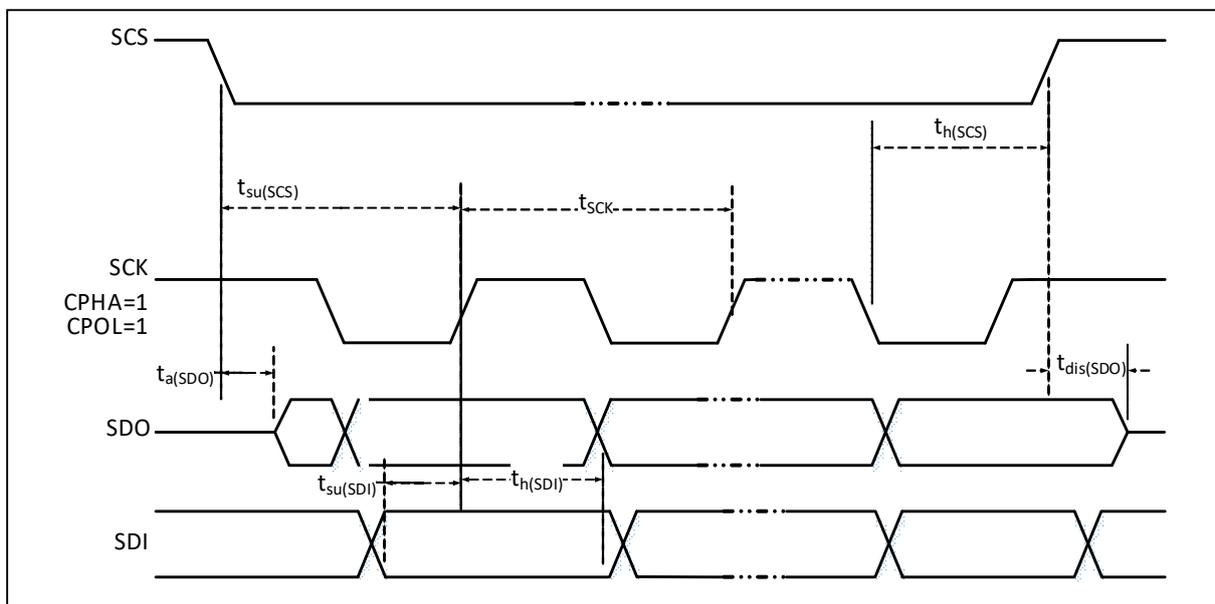
表 9-4 SPI 参数表 ( $AV_{DD33} = 3.3V$ ,  $V_{DD10} = 3.3V$ ,  $T_A = 25^\circ C$ )
