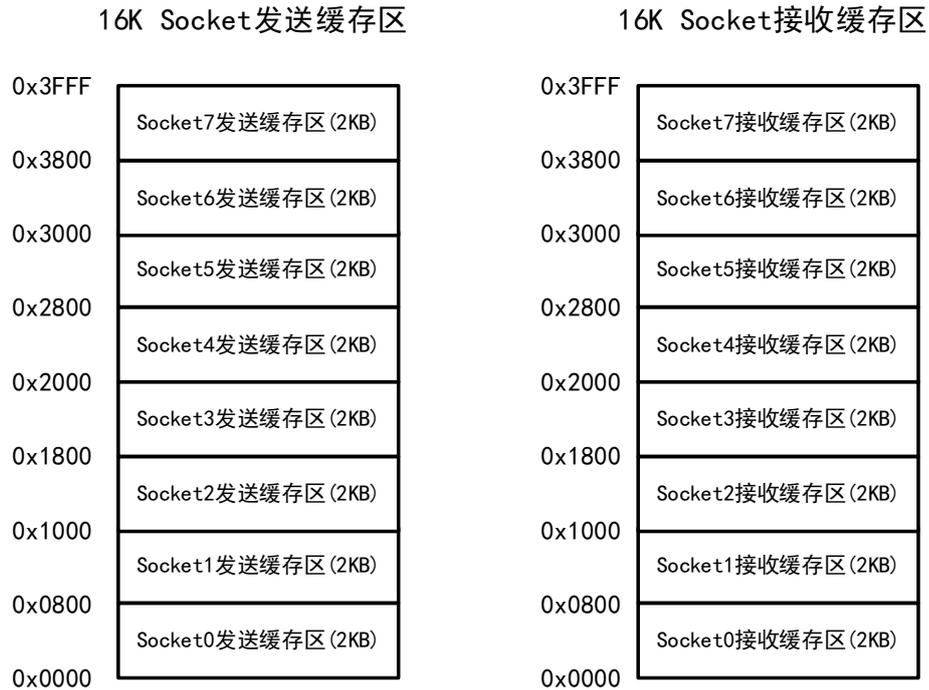
CH394Q 位每个 Socket  $n$  ( $n = 0\sim 7$ ) 提供了独立的发送和接收内存缓冲区，共有 16K 接收缓存区与 16K 发送缓存区。
