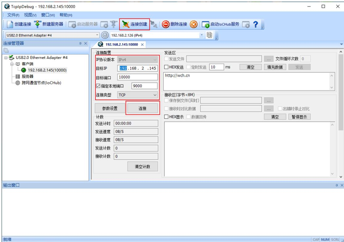
连接成功后“连接”按钮会变成“断开连接”，并且“连接”按钮左侧和“连接管理器”中的对应子节点左侧标识会由深绿变成浅绿色表示连接成功，下方输出窗口中也会给出成功提示：
