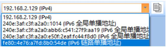
IP 选择下拉框用来展示对应网卡的 IPv4/IPv6 地址信息, 并提示 IPv6 各地址作用域方便用户选择合适的地址进行通信, 选择 IPv6 地址后便会指定该地址为通信时绑定的本地地址; “复制 IP”按钮可以将选中的 IP 地址复制到剪切板, 方便调试时使用。
