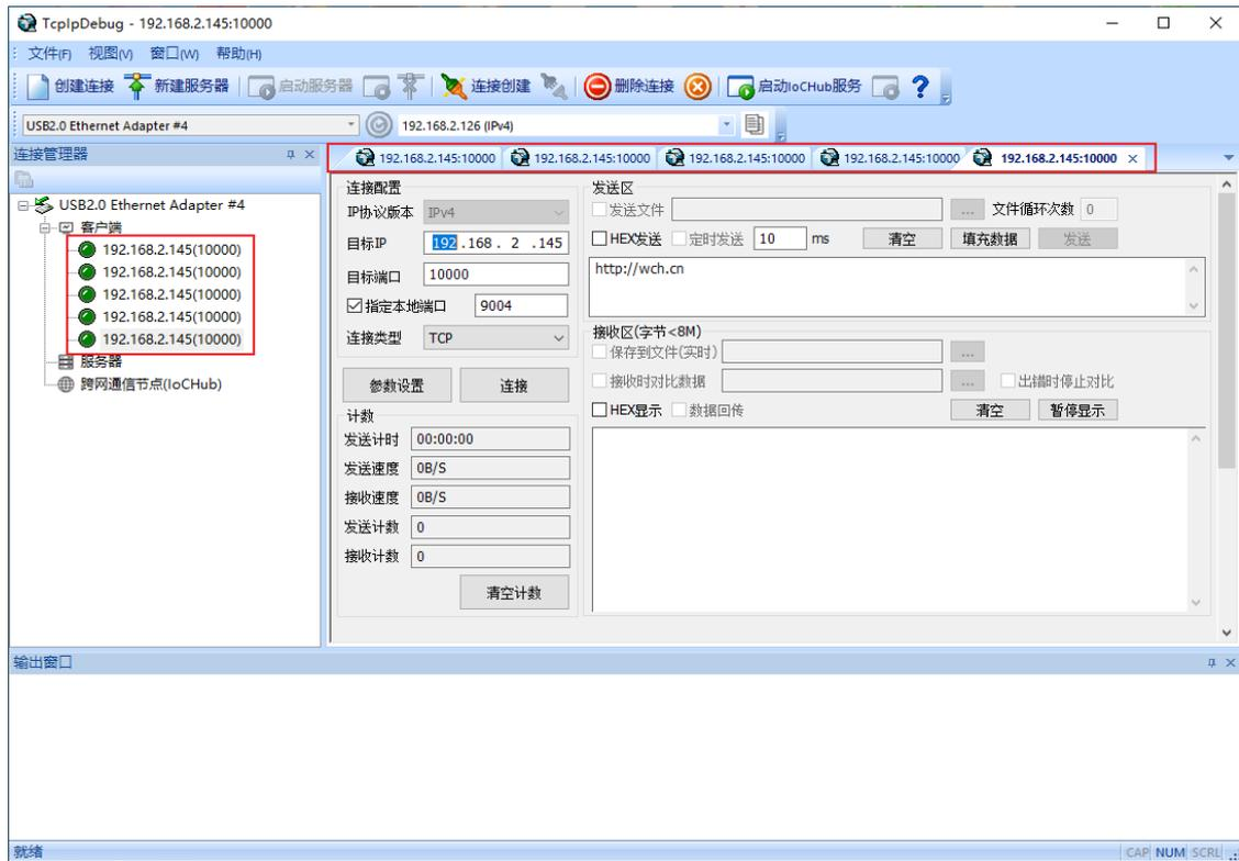
删除连接可以点击工具栏“删除连接”按钮或者右击“连接管理器”中想要删除的连接节点，在弹出菜单中选择“删除客户端”选项或者直接点击调试界面标题旁的“×”号：
