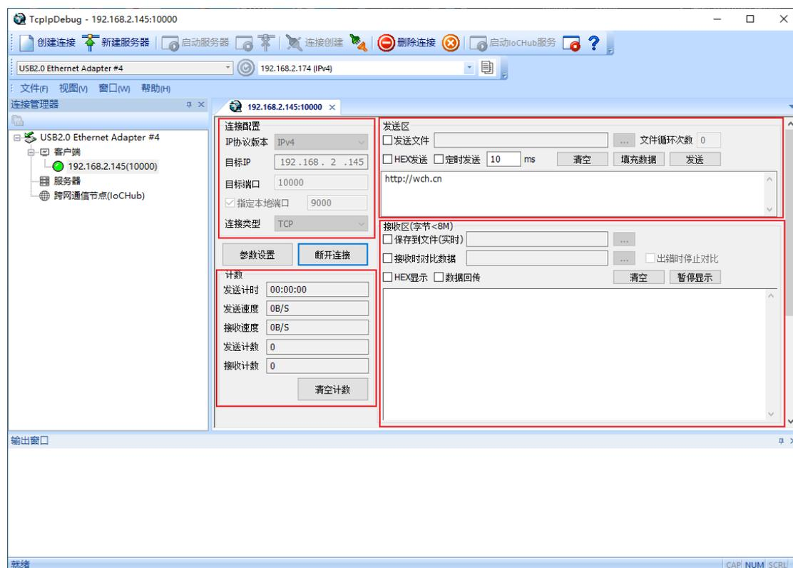
“连接配置”在创建连接时用到，“计数”区是在我们调试过程中会显示发送/接收速度以及发送/接收数量，“清空计数”按钮可以清空全部的数据，全都从 0 开始计数。
