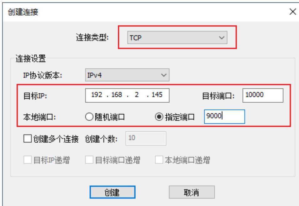
点击创建后即完成可客户端的创建，弹出客户端界面并在左侧“连接管理器”下的“客户端”节点下生成新创建的连接：
