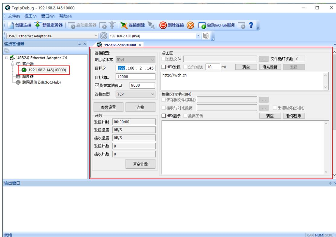
TcpIpDebug 支持多个客户端同时创建，勾选“创建多个连接”后填写需要创建的个数
