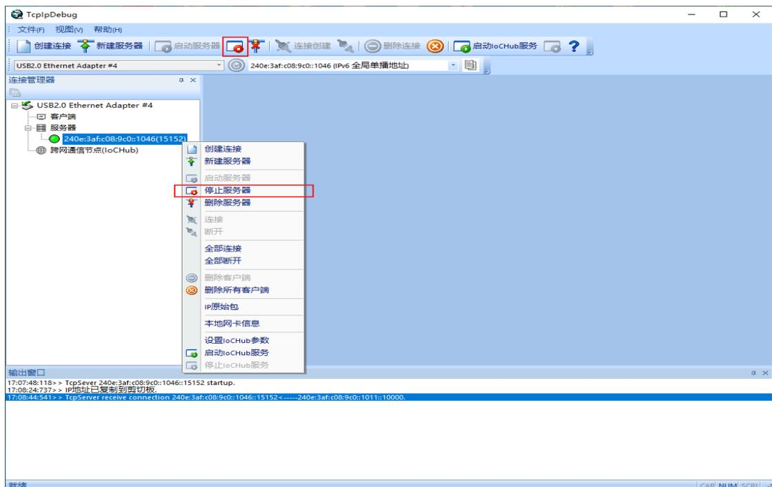
停止服务器后服务器节点左侧的标识会变回深色表示服务器处于未启动状态, 下方输出窗口会给出服务器停止提示;
