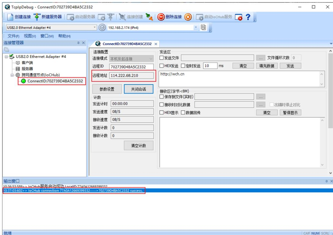
连接成功后会显示对端 IP 地址，下方输出窗口也会有打开会话成功提示。主动打开会话时，如果对端设置了会话密钥，则会弹窗提示输入对方的密钥：
