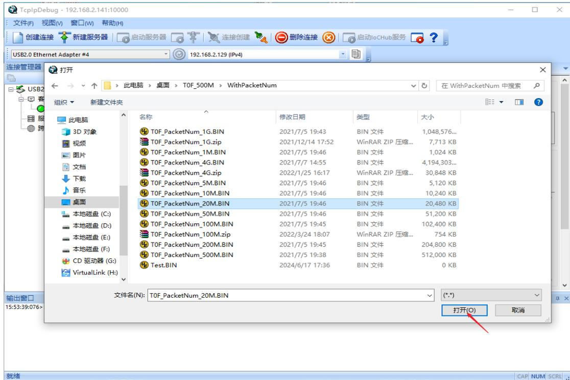
文件循环次数输入框可以填写想要循环发送的次数，点击“发送”按钮，即可开始发送文件，发送文件时原本文件路径框会显示发送次数及本次进度：
