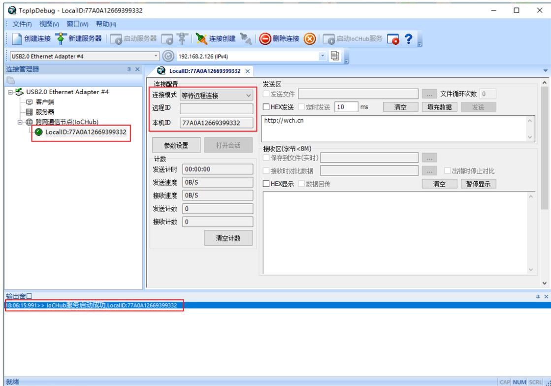
创建完成后进去调试界面可以看到“连接管理器”-“跨网通信节点（IoCHub）”下生成了一个子节点，并显示了本机 ID，下方输出窗口会有 IoCHub 服务启动成功的提示，如果 IoCHub 服务启动失败，请检查网络连接是否正常，确保正常后可以点击工具栏中的“启动 IoCHub 服务”按钮，或者右击“连接管理器”在弹出菜单中选择“启动 IoCHub 服务”选项：
