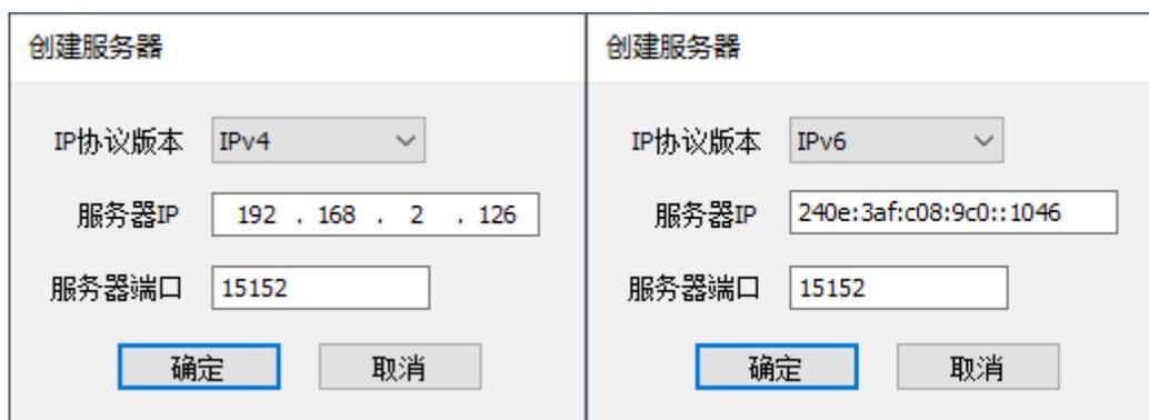
创建界面可在“IP 协议版本”处选择要创建 IPv4 或 IPv6 服务器，如果选择 IPv6 模式，软件会自动选择作用域最大的 IP 作为服务器地址；
