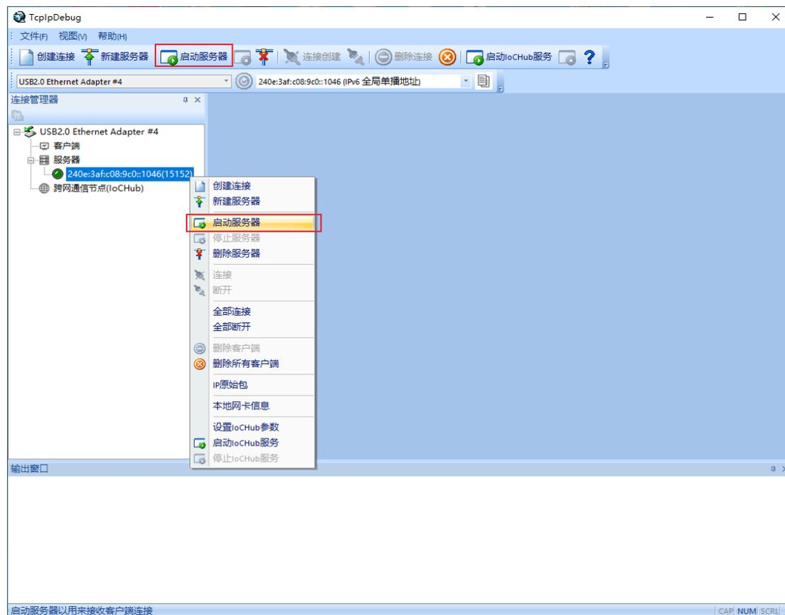
启动服务器成功后创建的服务器节点左侧的标识会由深绿变为浅绿代表启动成功,下方输出窗口也会有服务器启动成功提示:
