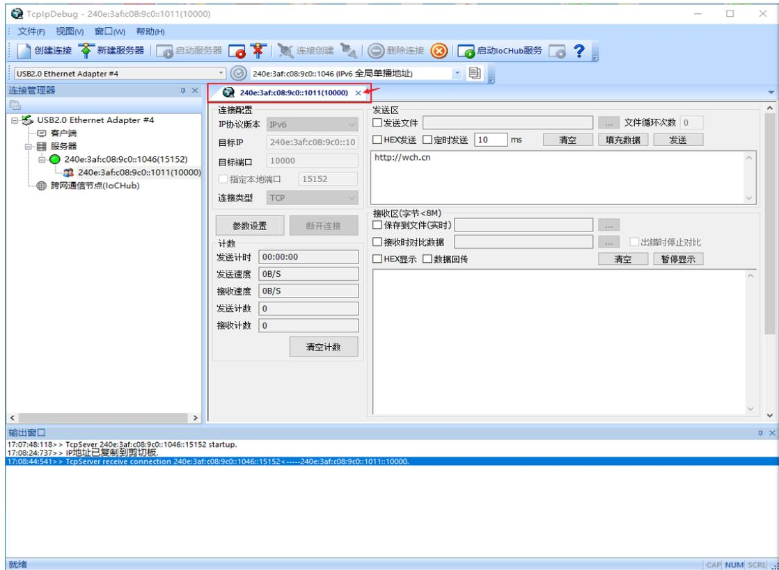
客户端断开连接后服务器端创建的子连接也会自动删除，并在下方输出窗口中给出断开连接提示。
